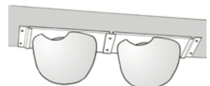
▲ Reihenmontage mit Flachverbinder
