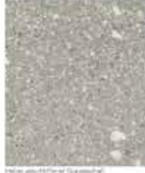
Heller geschliffener Gussasphalt
